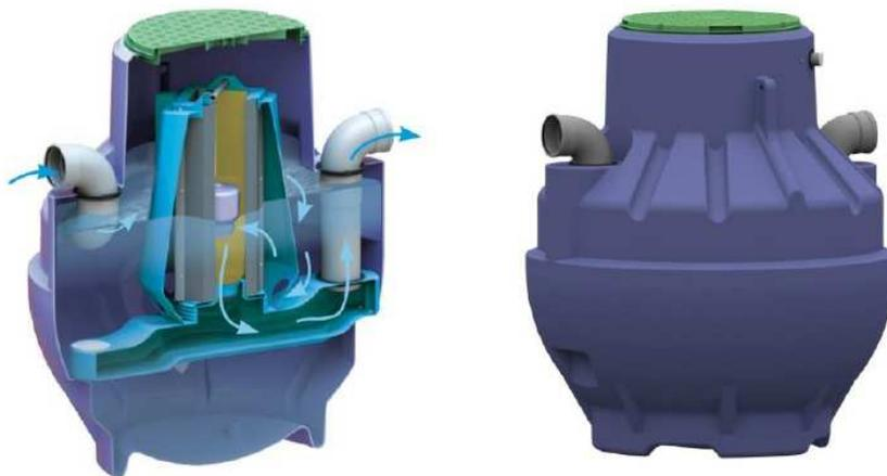
El funcionamiento de un separador de hidrocarburos está basado en el hecho de que los hidrocarburos tienen una densidad inferior a la del agua. El diseño de la cuba favorece los rendimientos del proceso de separación, que se ven incrementados por el flujo hidráulico interno y el filtro coalescente que favorece la agrupación de las pequeñas gotas de hidrocarburo, aumentando su volumen y facilitando su flotación.
